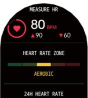
**Puls:** Tippen Sie kurz auf das Puls-Display und starten Sie damit die Pulsmessung. Zum Beenden erneut kurz Tippen. Die Daten werden automatisch an die APP zur Analyse übertragen. Ein Messzyklus dauert ca. 20 Sekunden. In der APP kann auch eine regelmäßige automatische Messung aktiviert werden („Vollzeit-Herzfrequenz“). Ebenso kann eine Herzfrequenzwarnung aktiviert werden (z.B. Alarm ab Puls 160 BPM).
