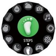
**Schnellmenü:** Ausgehend von der Normalanzeige (Uhrzeit), wischen Sie bitte nach rechts. Die Funktionen werden im runden Kreis angezeigt und können durch einen Tipp ausgewählt werden. Anschließend auf das mittlere Symbol tippen, um diese Funktion zu starten. Das Schnellmenü kann in den Einstellungen (Zahnradsymbol) zwischen Raster- und Listenansicht geändert werden.
