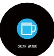
**Trinkalarm:** Wird diese Funktion in der APP aktiviert, erhalten Sie nach in einem von Ihnen gewählten Intervall eine Vibration der Smartwatch, die Sie daran erinnert, etwas zu trinken. Diese Funktion kann nur über die APP eingestellt werden.
