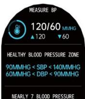
**Blutdruck:** Die Messung des Blutdrucks erfolgt auf optischem Wege (ohne Manschette) und sollte am linken Arm stattfinden. Eine Messung starten und beenden Sie durch kurzes Tippen auf das Display. Die APP zeigt Ihnen anschließend die Daten der letzten Messungen an. Ein Messzyklus dauert ca. 20 Sekunden. Die Smartwatch kann ein medizinisches Messgerät mit Manschette in der Genauigkeit nicht ersetzen!
