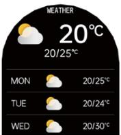
**Wettervorhersage:** Die Smartwatch übernimmt die aktuellen Wetterdaten Ihres Smartphones und zeigt sie im Display an (dies funktioniert nur bei bestehender Bluetoothverbindung mit dem Gerät). Diese Anzeigefunktion muss vorab in den Einstellungen der APP eingeschaltet werden (mittleren Menüpunkt antippen, „ANDERE“ wählen und „Wetterinformationen“ einschalten).
