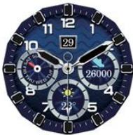
**Zeitanzeige:** Anzeige von Uhrzeit und Datum. Es kann zwischen verschiedenen Darstellungsarten gewählt werden: Hierzu zwei Sekunden mit dem Finger auf das Display drücken. Nun kann durch seitliches Wischen das gewünschte Display ausgewählt werden. Zum Speichern 1x kurz auf das Display tippen. Die Uhrzeit kann nicht manuell eingestellt werden, sie synchronisiert sich automatisch mit der Uhrzeit des Smartphones.
