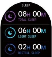
**Schlafen:** Das Gerät muss hierzu eingeschaltet und in der Nacht am Handgelenk getragen werden. Es zeichnet nun die Schlafphasen auf, speichert diese Daten und überträgt sie zur weiteren Schlafanalyse an die APP. Die Aufzeichnung der Daten erfolgt automatisch in der Zeit von 20:00 – 08:00 Uhr. Erst danach stehen die Daten in der APP zur Ansicht bereit.
